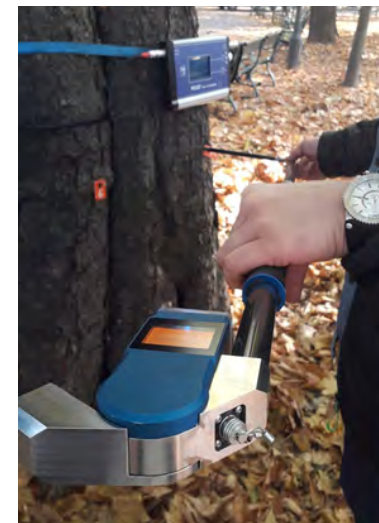
Rejestrowanie pomiaru tomografem akustycznym.
